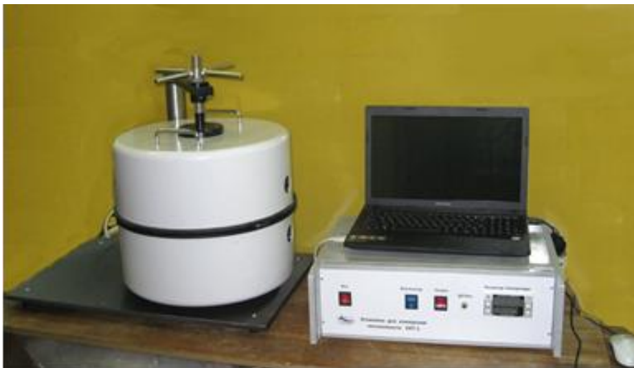
Рис. 2. Внешний вид калориметрической измерительной системы
