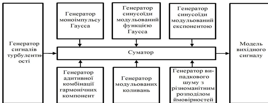
Рис. 3. Структурна схема генератора вихідних моделей сигналу
