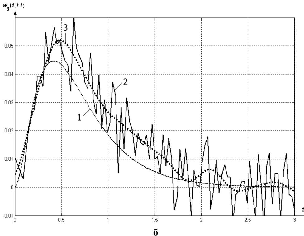
**Рис. 1.** Результат идентификации диагональных сечений ЯВ второго (а) и третьего (б) порядков НДС с помощью аппроксимационного метода ( $N = 4$ ) при погрешности измерений 1%: эталонные ЯВ (1); идентифицированные ЯВ (2); идентифицированные ЯВ при применении вейвлет-фильтрации на основе вейвлета *coif4* с уровнем разложения  $L = 4$  (3)
