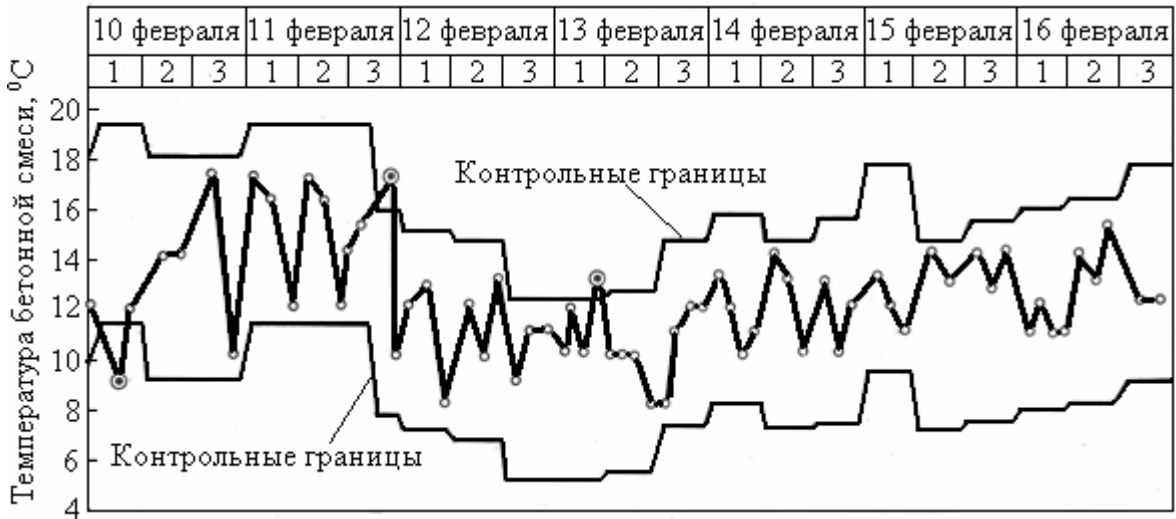
Рис. 5. Контрольная карта индивидуальных значений температуры бетонной смеси
