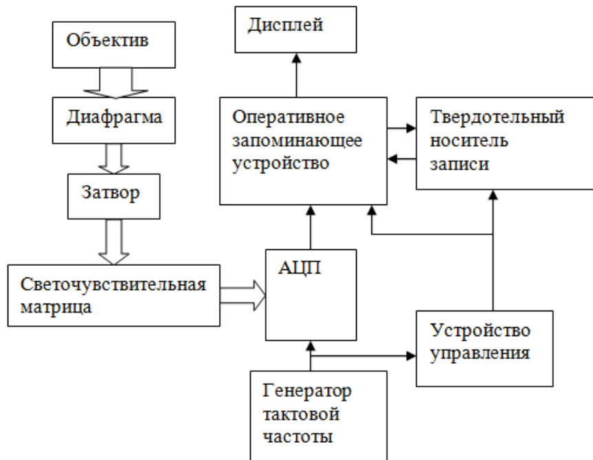
Рис. 1. Функциональная схема цифрового аппарата записи изображений
