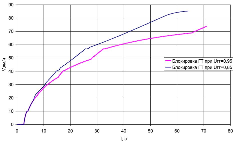
Рисунок 5 – Изменение скорости движения БТР-4 при прохождении дистанции 1000 м с ранней (кинематическое передаточное отношение ГТ,  $U_{gt} = 0,85$  ) и штатной ( $U_{gt} = 0,95$ ) блокировкой ГТ
