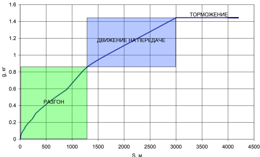
Рисунок 1 – Расход топлива в процессе движения машины
