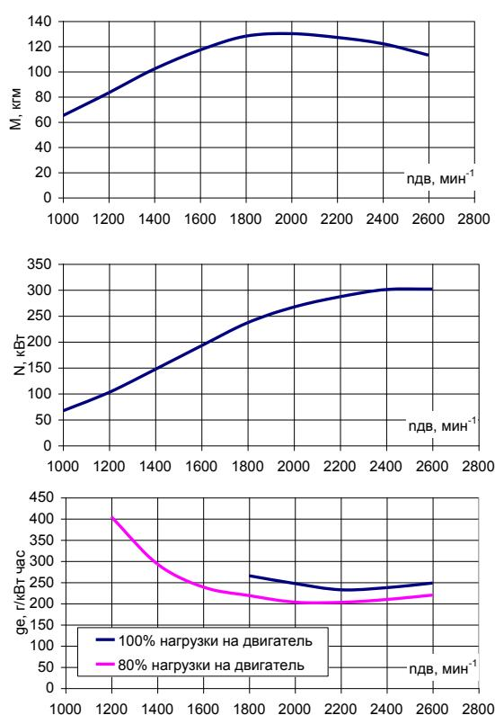
Рисунок 2 – Внешние характеристики двигателя ЗТД-3А
