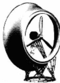
Рисунок 2 – Внешний вид ветроэнергетической установки с КВП
