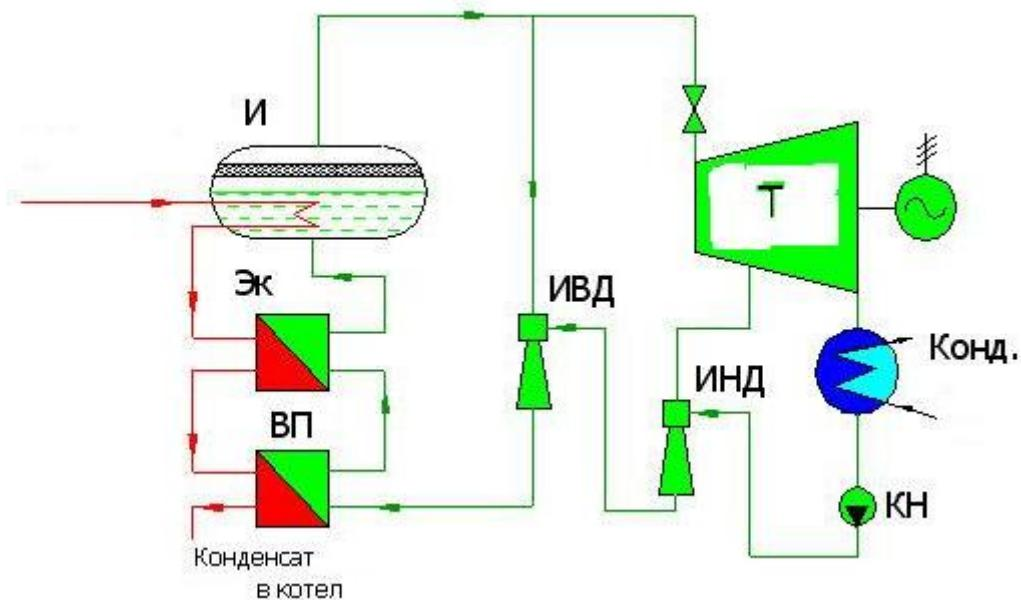
Рисунок 2 – Тепловая схема паротурбинной установки с низкокипящим рабочим телом
