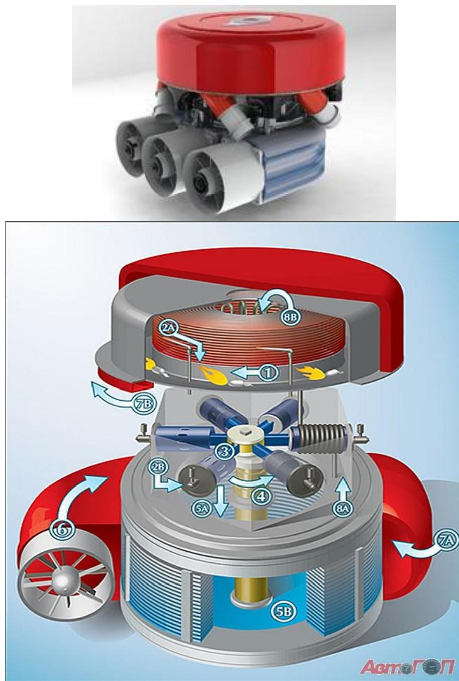
Несмотря на то, что принципиально новых технических решений в этом двигателе нет, интересна его компоновка, обеспечивающая высокую степень использования теплоты топлива и компактность. Представляет также интерес и материал, использованный при его создании – керамика – что предотвращает теплорассеивание.
