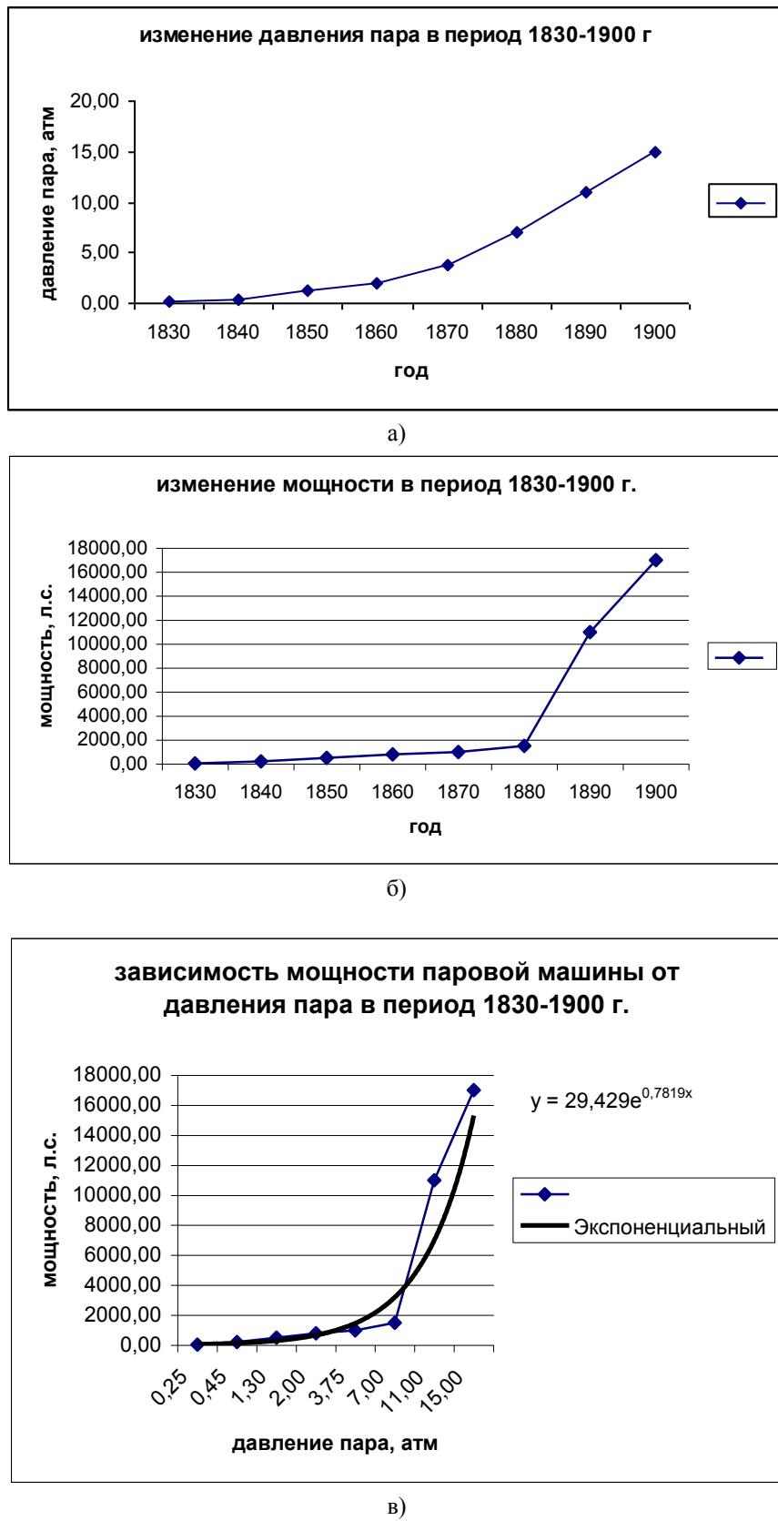
Рисунок 1 – Изменение давления пара (а) и мощности (б) паровых машин в период 1830–1900 г., и зависимость мощности от давления пара (в)
