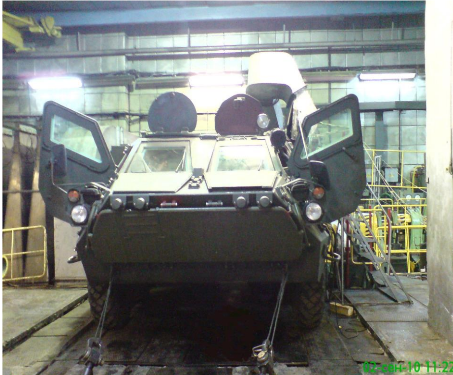
Рисунок 4 – Установка БТР-4Е на стенде комплексных испытаний моторно-трансмиссионных отделений
