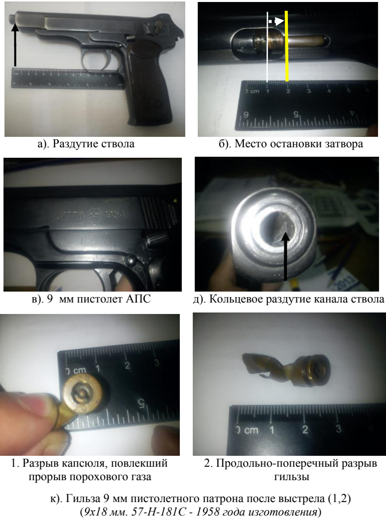
Рисунок 2 – Повреждения, вызванные применением боеприпасов послегарантийных сроков хранения для пистолетов
