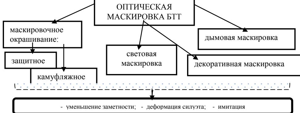
Рисунок 3 – Употребительные способы оптической маскировки БТ
