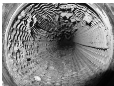
Рисунок 3 – Фотографии входных коллекторов по соку после разборки
