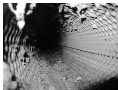
Рисунок 3 – Фотографии входных коллекторов по соку после разборки
