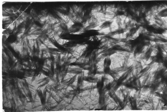
Рисунок 1 – Волокнистый продукт со структурой \left( \begin{array}{c} \text{-Al} \\ \text{-Al} \end{array} \right) \text{O} \begin{array}{c} \text{H} \\ \text{HO} \end{array} \text{Al} после выдержки при 800 °С. Увеличение в 20000 раз
