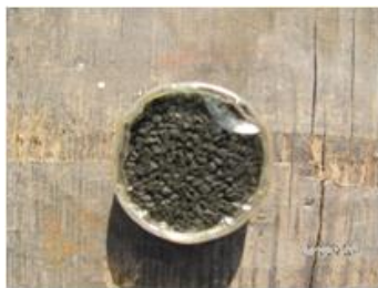
Рисунок 7 – Дополнительный воспламенитель из дымного пороха, размещенный в ампуле из нитроосновы
