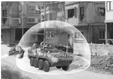
Рисунок 2 – Принцип действия КАЗ Trophy
