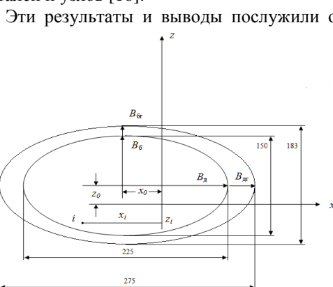
Рисунок 6 – Эллипс полигонного рассеивания торпед с учетом геронтологических изменений АБ
