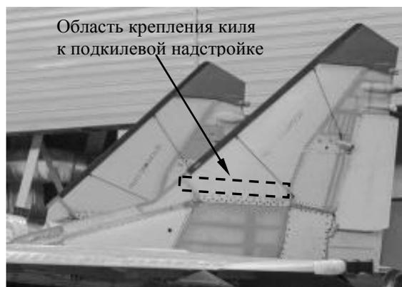
Рисунок 1 – Вертикальное оперение самолёта МиГ-29
