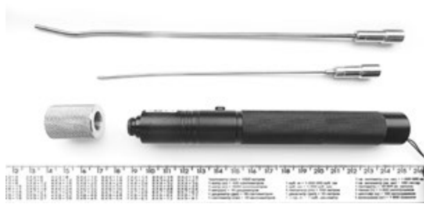
Рис. 1. Устройство лазерное мобильное для облучения глубоких раневых каналов и полостей
