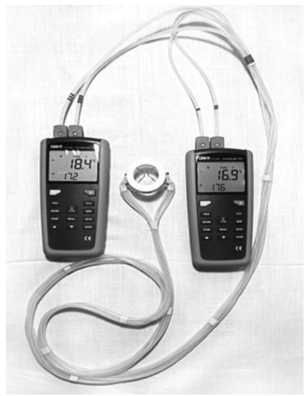
Рис. 1. Измерительный интраоперационный термодарный 4-канальный комплекс (КИИТ-4) с термодарами длиной 3, 8, 13 и 18 мм
