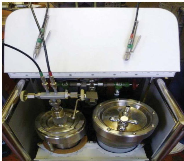
Рис. 2. Друге покоління установки струменевого гідроскальпеля (НАУ, 2010 р.)
