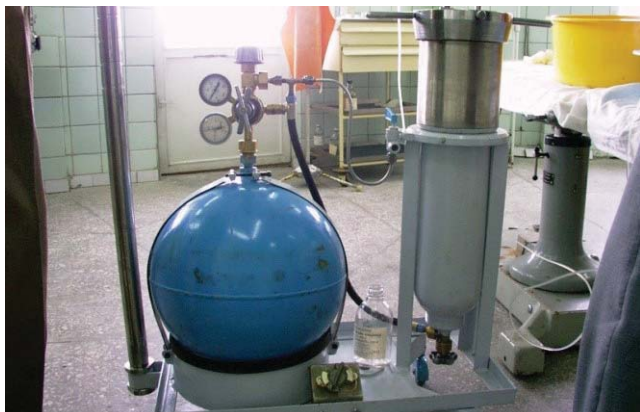
Рис. 1. Перше покоління установки струменевого гідроскальпеля (НАУ, 1994 р.)
