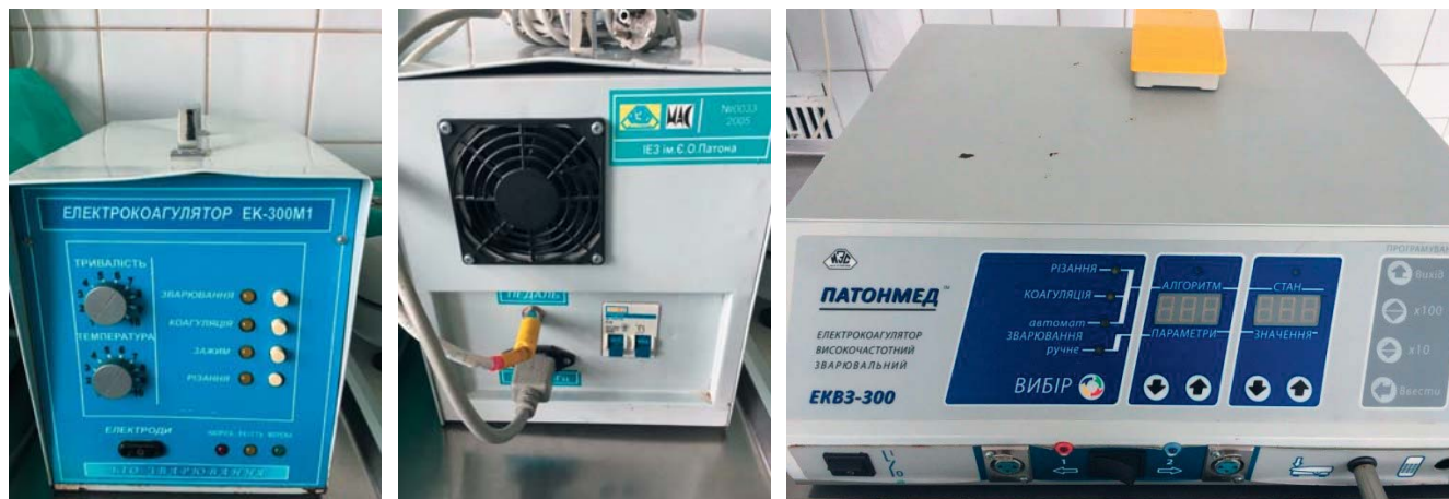
Рис. 1. Електрозварювальні хірургічні комплекси ЕК300 М1 та «Патонмед ЕКВ3-300 М1»
