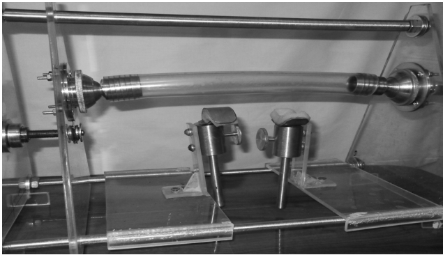
Рис. 1. Стенд с макетом кишки из ПВХ трубки (Пат. Украины № 60703)
