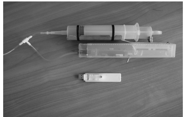
Рис. 1. Аппаратная часть комплекса для дистанционной компьютерной дебитоманометрии
