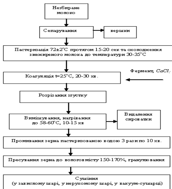
Рис.3. Технологічна схема отримання харчового казеїну (зразок 3)
