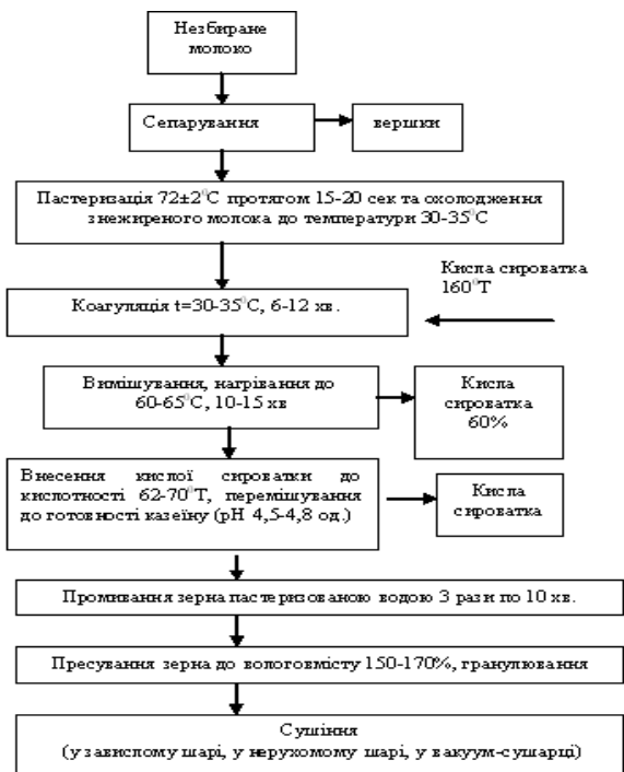
Рис.1. Технологічна схема отримання харчового казеїну (зразок 1)
