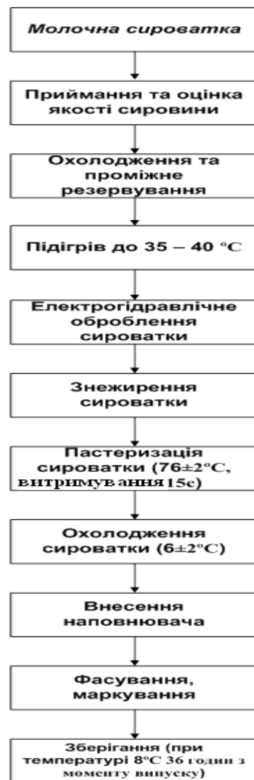
Рис.2. Технологічна схема виготовлення сироватки
