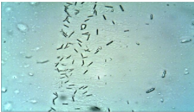
Рис.3. Фотографія структури твердої фази анодита, збільшення в 720 раз
