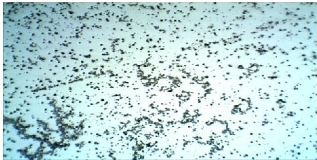
Рис.7. Фотографія структури твердої фази води после омагнічювання, збільшення в 720 раз
