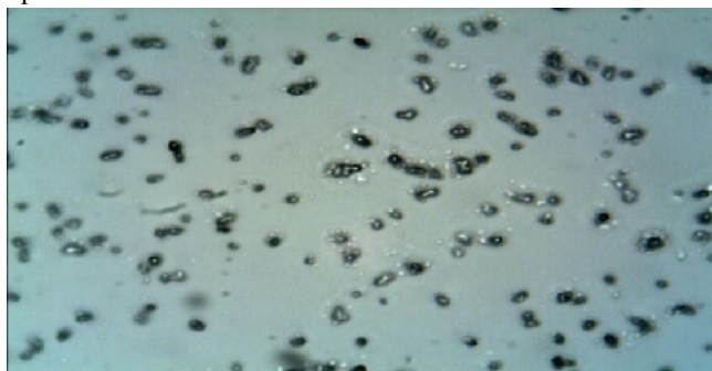
Рис. 1. Фотография структуры твердой фазы водопроводной воды, увеличение в 720 раз
