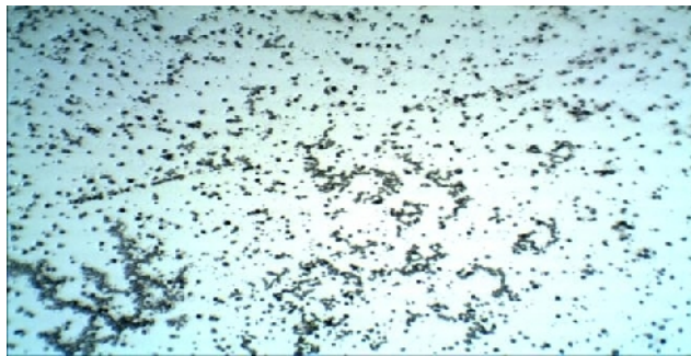
Рис.7. Фотографія структури твердої фази води после омагнічювання, збільшення в 720 раз
