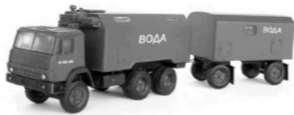
Рис. 5. Вариант размещения системы для получения воды из воздушного бассейна с производительностью 250-500 литров воды в час
