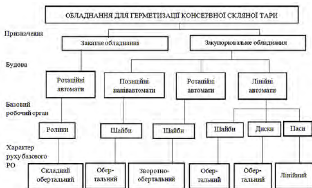
Рис. 1. Класифікація обладнання для герметизації консервної скляної тари
