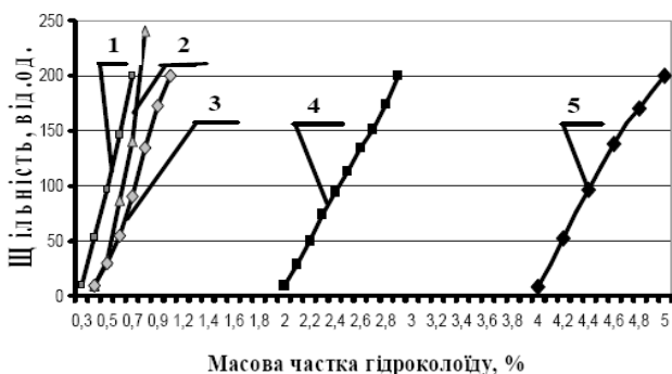
Рис. 1. Щільність гелів в залежності від масової частки і виду гідроколоїду: 1 – камедь рожкового дерева ( C_{01} = 0,3\% ); 2 – карагінан ( C_{02} = 0,4\% ); 3 – камедь гуару ( C_{03} = 0,4\% ); 4 – пектин ( C_{04} = 2,0\% ); 5 – крохмаль ( C_{05} = 4,0\% )
