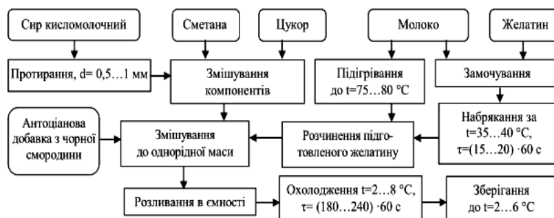
Рис. 1. Принципова технологічна схема виробництва вітамінізованого бланманже з використанням антоціанової добавки
