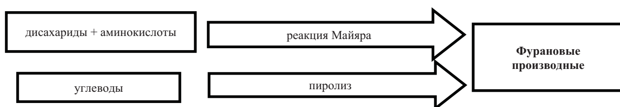
Рис. 5 Механизм образования фурановых производных в вине
