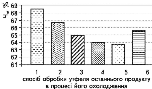
Рис. 3. Залежність чистоти міжкристального розчину від способу обробки утфелю останньої кристалізації в кінці політермічної кристалізації: 1 — розкачка водою, 2 — розкачка мелясою, 3 — проміжний нагрів на 5 °C, 4 — проміжний нагрів на 7 °C, 5 — проміжний нагрів на 10 °C, 6 — проміжний нагрів на 12 °C
