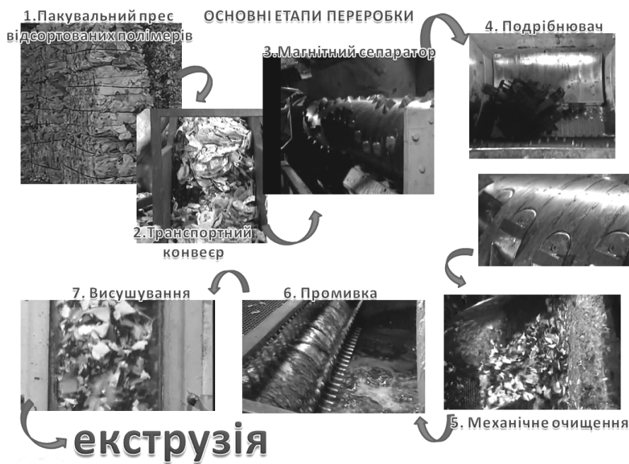
Рис. 1. Схема послідовності переробки полімерів
