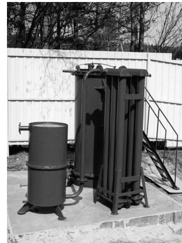
Рис. 1. Дослідний зразок газогенераційного енергетичного комплексу ГЕКА-3
