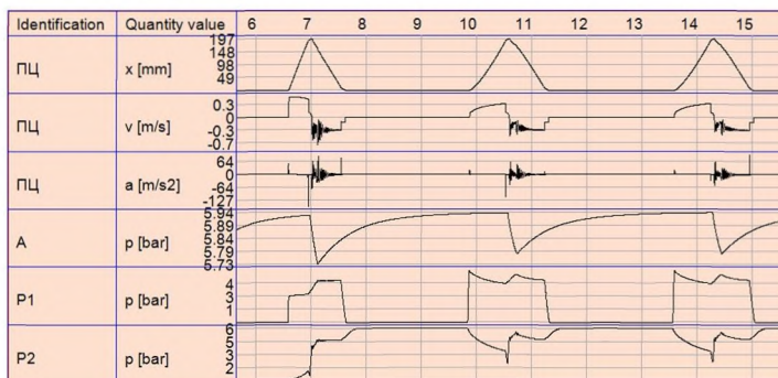
Рис. 6. Результати аналітичних досліджень рекуперації енергії від часу роботи за допомогою програми FluidSIM-P
