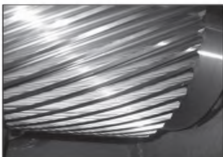
Рис. 4. Внешний вид дефектов на зубьях редуктора
