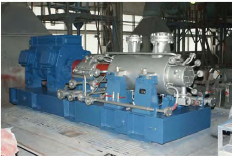
Центробежная компрессорная установка с сухими газодинамическими уплотнениями 2ГЦ2 - 16/27-37УХЛ1 для циркуляции водородосодержащего газа в блоке изомеризации нефти
