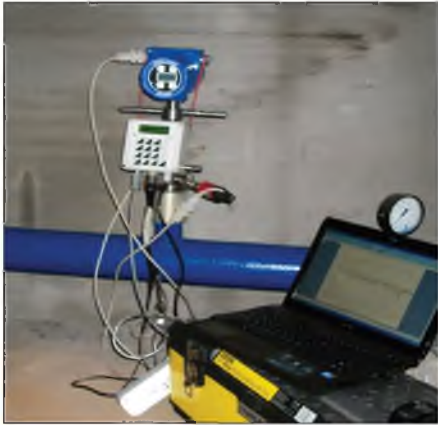
Рис. 3. Турбинный погружной расходомер-счетчик ТМП производства фирмы ЕМСО (США), сертифицированный в Федеральном агентстве по техническому регулированию и метрологии
