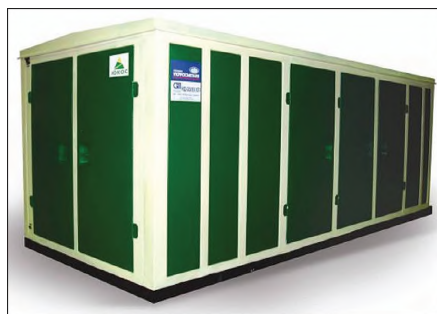
Рис. 9. Переносная контейнерная азотная станция с дизельным приводом для нагнетания 95% азота производительностью 20 м 3 /мин давлением 36 МПа
