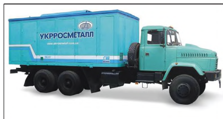
Рис. 10. Передвижная азотная станция с дизельным приводом для нагнетания азота с концентрацией 90% производительностью 24 м 3 /мин давлением 12 МПа
