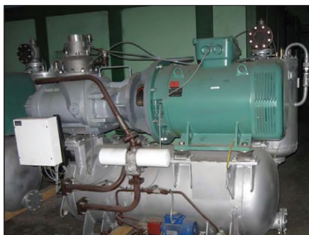
Рис. 3. Винтовая компрессорная установка для бурового станка ВВ-32/8М1У2 с винтовым блоком СЕ177G
