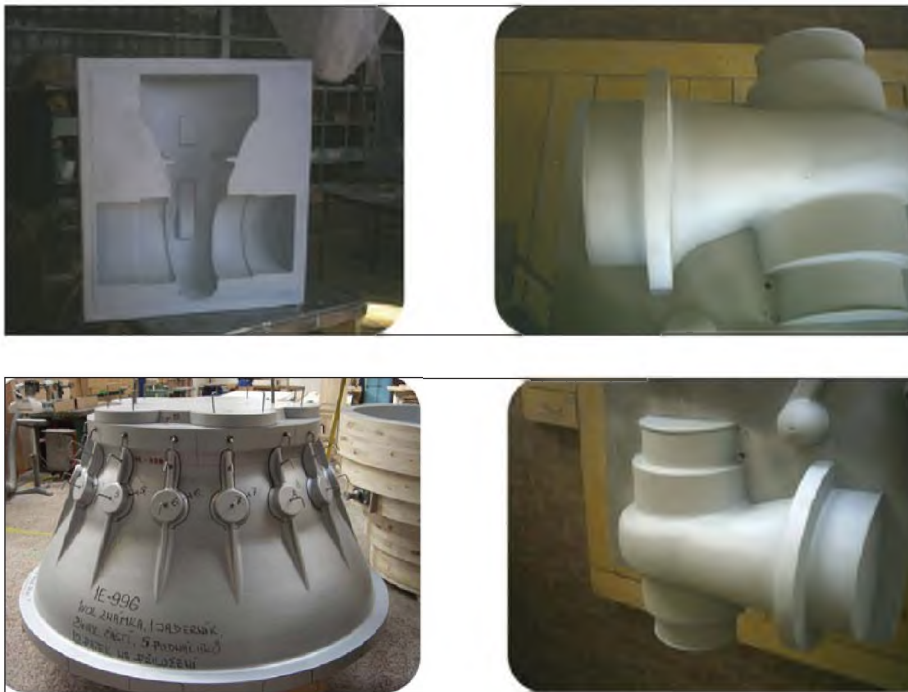
Рис. 7. Разновидность литейных моделей форм и стержней, изготовленных на установке «GREDA»
