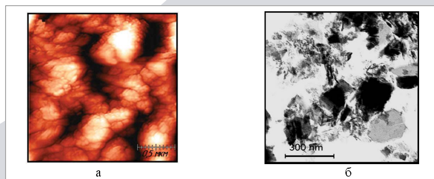
Рис. 1. Топография поверхности и наноструктура бемита: а – топография поверхности наноструктурированного бемита; б – наноструктура бемита
