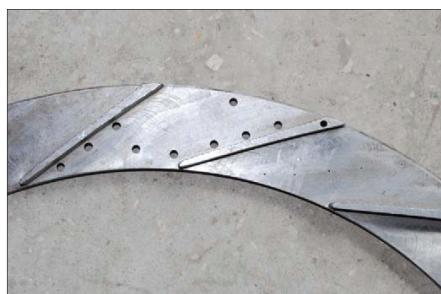
б) отборы статического давления на средней линии канала и отверстия для измерений при помощи трубок полного давления
