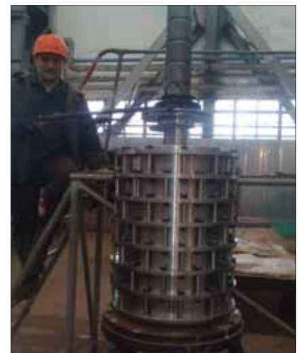
Рис. 2. Тепловая напрессовка рабочих колес при сборке съемной части многоступенчатого подпиточного насоса АЦНА 25-185
