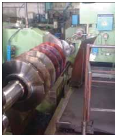
Рис. 1. Многоступенчатый ротор центробежного турбокомпрессора ГПА
