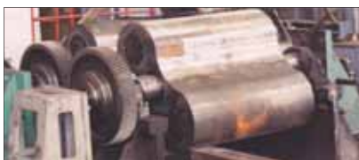
Рис. 5. Проверка зазоров при вращении рабочих органов типа РУТС перед общей сборкой компрессора технологического газа КГТ-317
