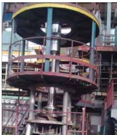
Рис. 3. Вертикальная сборка ротора главного циркуляционного насоса ГЦН-195М для АЭС
