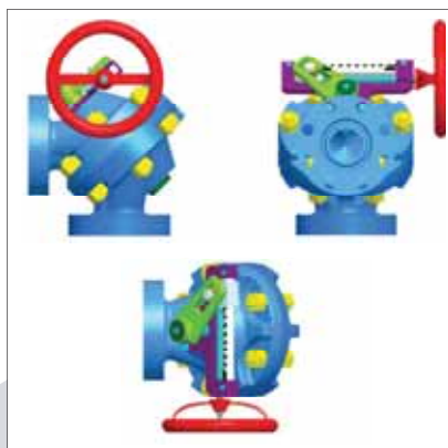
Рис. 3. Многофункциональная запорно-регулирующая дисковая задвижка с корпусом в угловом варианте сборки
