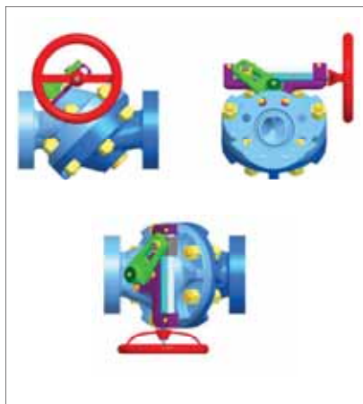
Рис. 2. Многофункциональная запорно-регулирующая дисковая задвижка с корпусом в проходном варианте сборки
