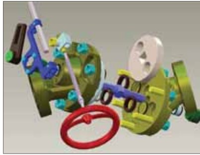
Рис. 5. Многофункциональная запорно-регулирующая дисковая задвижка в разобранном виде
