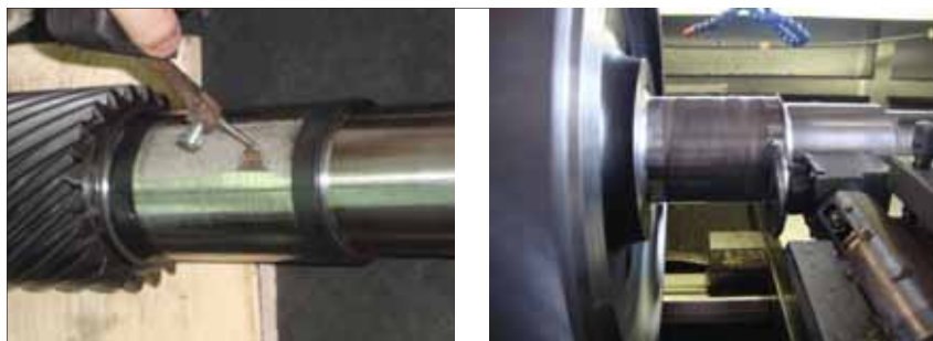
Рис. 13. ЭЭЛ подшипниковых шеек вал шестерни (а) и ППД подшипниковой шейки зубчатого колеса (б)
