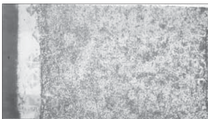
Рис. 8. Микроструктура поверхностных слоев ЭЭЛ никелем после обкатки шариком D_{ш}=10 мм, P_{cp}=2060 МПа. \times 400
