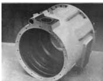
Рис. 6. Свободнопоршневой дизель-компрессор 18ДКСМ с корпусными деталями из высокопрочного чугуна
