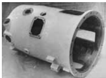
Рис. 6. Свободнопоршневой дизель-компрессор 18ДКСМ с корпусными деталями из высокопрочного чугуна
