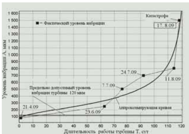
Рис. 4. Результаты контроля вибраций гидроагрегата и аппроксимация их графиком функции, отображающей механику разрушения металла
