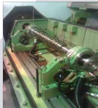
Рис. 8. Балансировка ротора подпиточного насоса АЦНА 25-190 на вакуумном разгонном стенде
