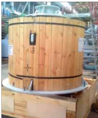
Рис. 3. Упаковка вертикального электродвигателя ВАН-118/51-8
