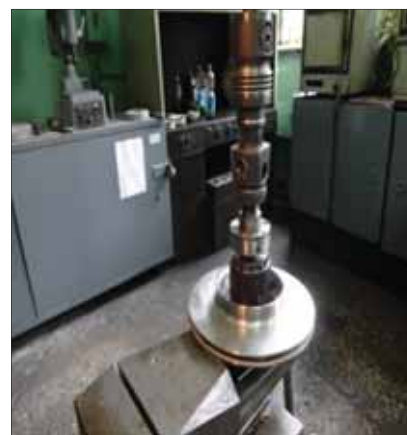
Рис. 7. Финишная обработка отверстия с глухим шпоночным пазом в рабочем колесе насоса ЦНА 150-90-2
