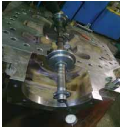
Рисунок 12. Приспособление для проверки биения ответственных поверхностей разъемного корпуса насоса КсА 1500-240-4: а – схема; б- общий вид (крышка снята)
