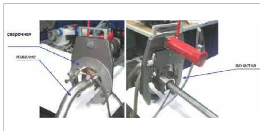
**Рис. 4. Крепление сварочной головки открытого типа на специальную оснастку**
